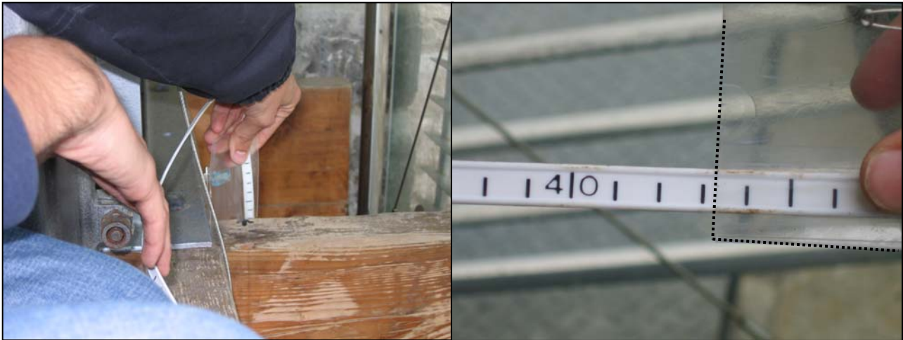
Fig.3 : Index de lecture du ruban porte-sonde (repère N) et méthode pratique pour apprécier le millimètre
