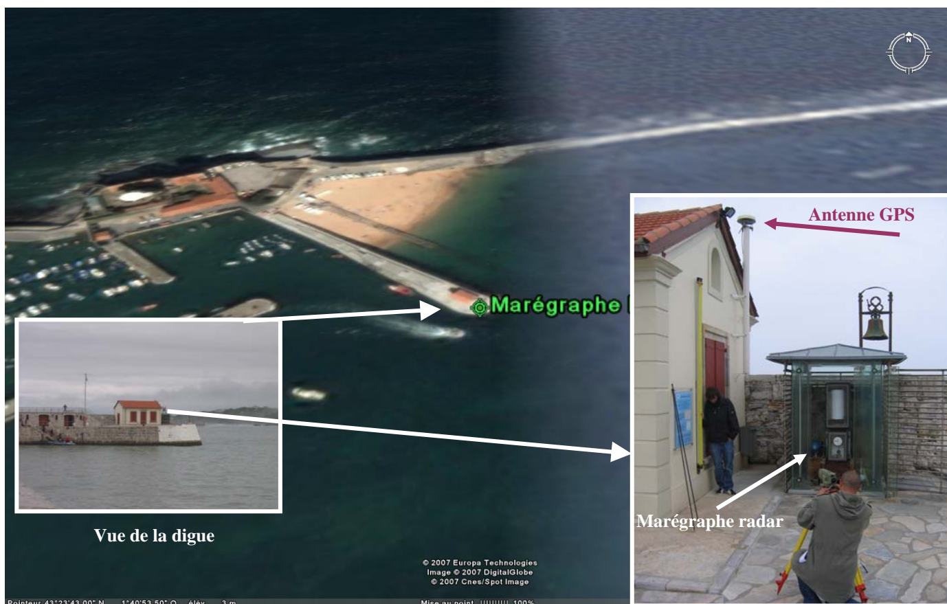
Fig.2 : Situation de l'observatoire de Socoa et de ses instruments permanents (Marégraphe, GPS)
