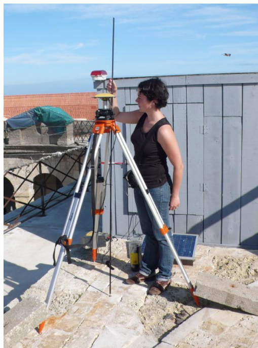
photo 6 : mesure de différence de hauteur entre la base de l'antenne GPS et le repère en bronze
