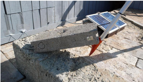
photo 5 : trépied Leica stabilisé par des parpaings en béton et panneau solaire
