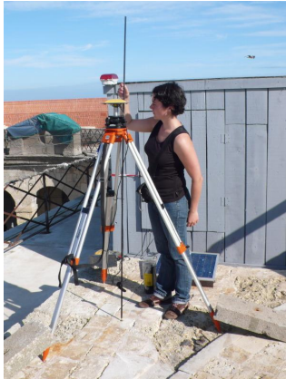
Schéma 9 : photos de l'antenne GPS et du panneau solaire servant à alimenter la batterie
