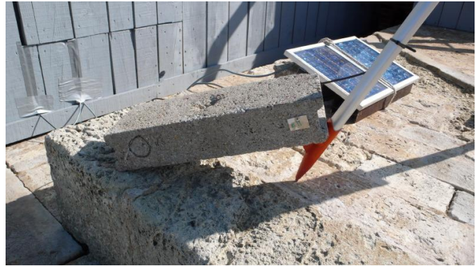
Schéma 9 : photos de l'antenne GPS et du panneau solaire servant à alimenter la batterie
